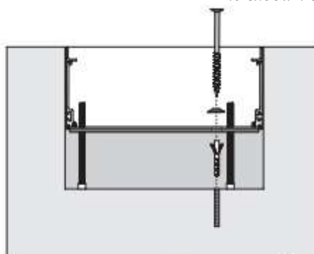
Фиксация системного конвектора, вид спереди
